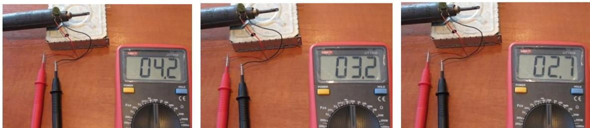
В нашем случае подопытный термистор работает вполне исправно, его сопротивление уменьшается одновременно с нагревом паяльника.
