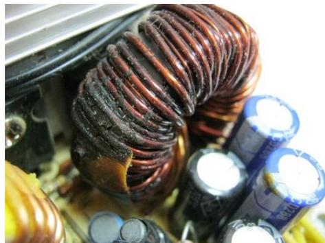
Проверка исправности трансформатора нужно начинать с внешнего осмотра. На этом этапе выявляются механические дефекты. Не существенные можно сразу устранять. Проверка на короткую замыканию между обмотками и обмоткой с корпусом выполняется при помощи мультиметра.
