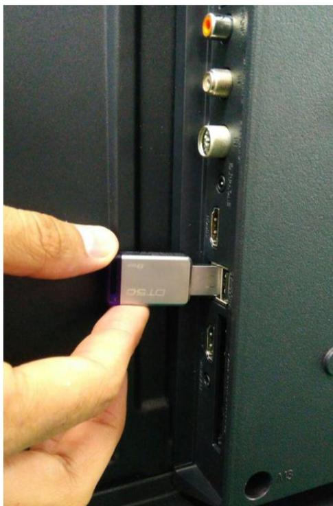
3. Для начала обновления ПО следует нажать на ПДУ ( пульт дистанционного управления) нажать кнопку **SOURCE** Набрать комбинацию из кнопок «1147» или на кнопку **МЕНЮ**, перейти на функцию «контраст» и нажать 2526. Перейти на пункт **SWUPGRADE** «Обновление программы» Активизировать вкладку «**UPGRADE TV**» Нажать на кнопку «Вправо» на ПДУ.
