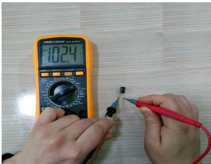
**ВАЖНО:** Если во время касания щупами конденсатора, мультиметр пищит и показывает ноль, то это говорит о коротком замыкании в конденсаторе. Если мультиметр сразу показывает единичку, то в конденсаторе случился обрыв. В любой из описанных ситуаций, следует выкинуть конденсатор, поскольку он не рабочий.
